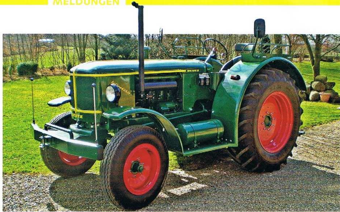
Mächtig viel Deutz: Der Schlepper mit dem luftgekühlten Vierzylindermotor leistet satte 60 PS.
